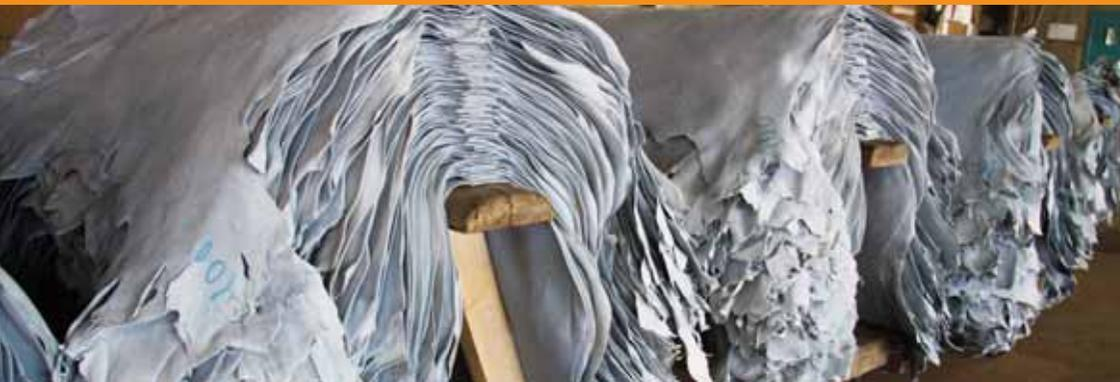
L'opérateur de travail de rivière effectue toute une série d'opérations visant à préparer les peaux d'animaux pour leur tannage. Le but de ces opérations est de retirer les poils et chairs à l'aide d'opérations chimiques et mécaniques sur des machines.
